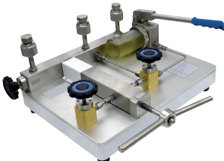
Пресс гидравлический УСД-1200МЗ является вспомогательным оборудованием, применяемым для поверки и калибровки средств измерения давления методом сличения показаний эталонного и рабочего средств измерений. Пресс может использоваться как в полевых, так и в лабораторных условиях.
