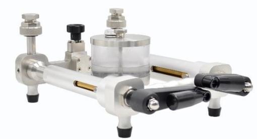
Пресс гидравлический УСД-700М2 является вспомогательным оборудованием, применяемым для поверки и калибровки средств измерения давления методом сличения показаний эталонного и рабочего средств измерений. Пресс может использоваться как в полевых, так и в лабораторных условиях.
