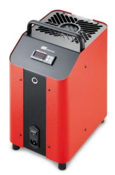
Состоит из металлического блока с увеличенным внутренним диаметром 60 мм и глубиной погружения 150 мм. Нагрев и охлаждение осуществляется с помощью установленных элементов Пельтье.
