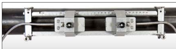
Измерение датчиками, смонтированными на портативном Variofix VP
