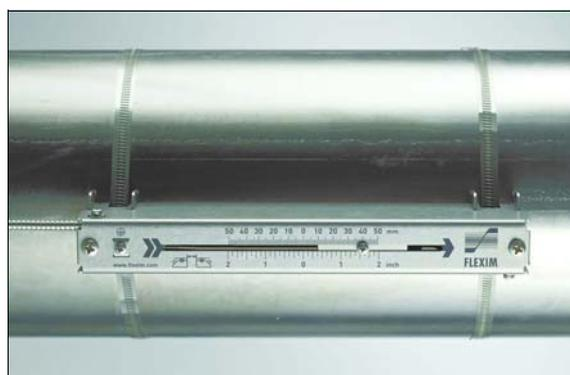
Измерение датчиками, смонтированными на Variofix L
