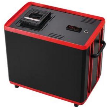
Данная модель представляют собой высокотемпературый микропроцессорный сухоблочный калибратор температуры.
