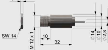
Детектор (измерительная головка) со встроенными линзами SF
