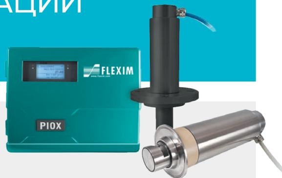
PIOX® R – рефрактометр, принцип работы основан на определении показателя (коэффициента) преломления (рефракции) проходящего луча света через измеряемую среду. Коэффициент рассчитывается по углу преломления с использованием закона преломления Снелла. Применяется для идентификации химических соединений, количественного и структурного анализа, определения физико-химических параметров веществ.
