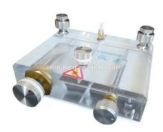
Пресс УСД-05П является вспомогательным оборудованием, применяемым для поверки и калибровки средств измерения давления методом сличения показаний эталонного и рабочего средств измерений. Пресс может использоваться как в полевых, так и в лабораторных условиях.
