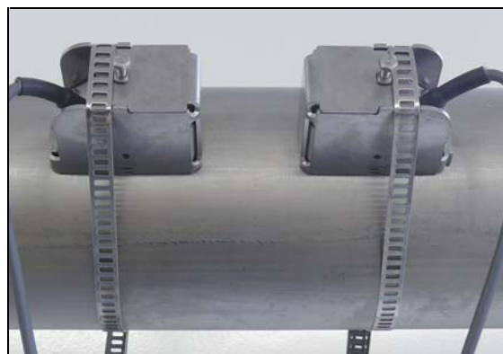
Датчики в монтажном башмаке, крепление затяжным ремнем
