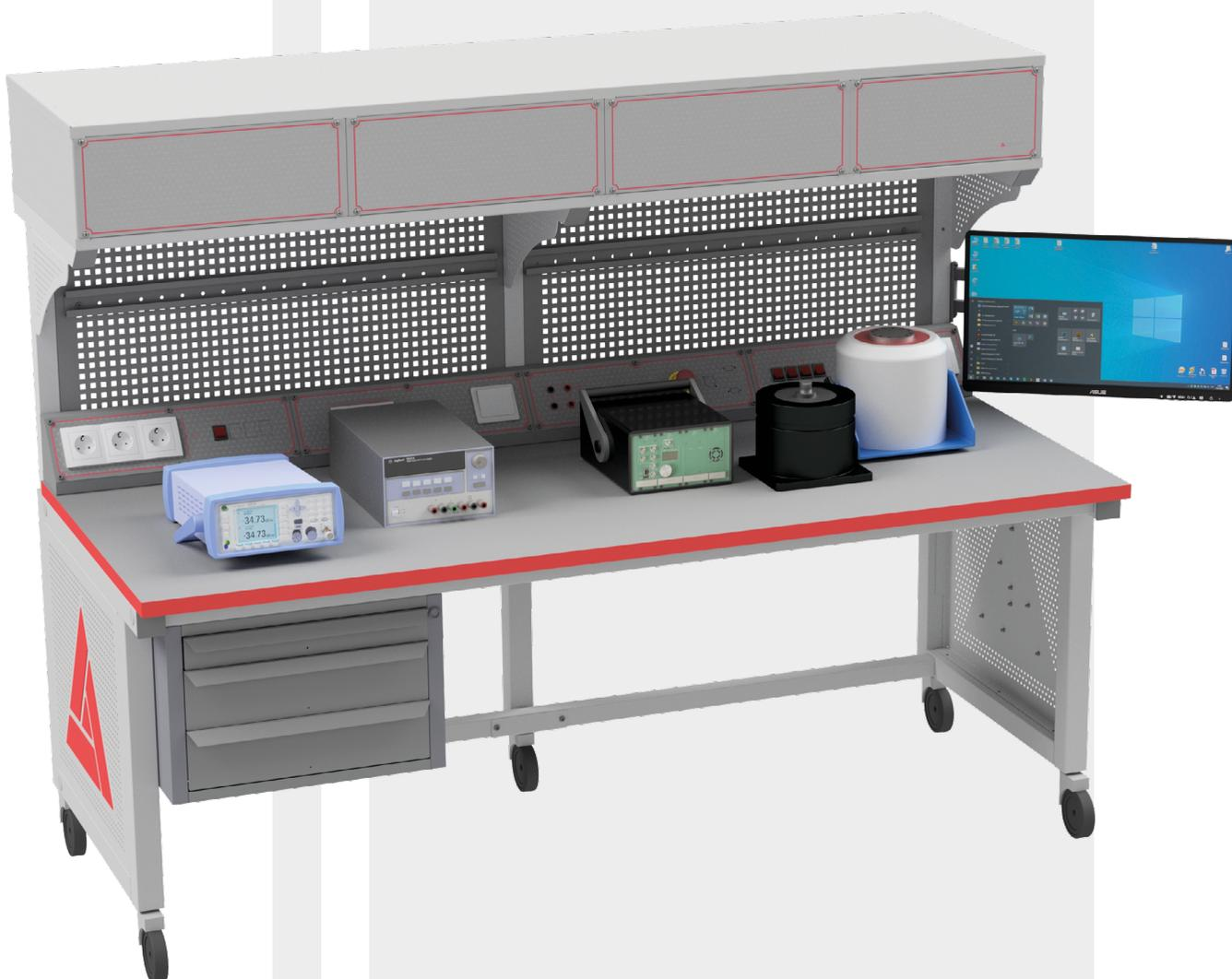
Метрологический стенд предназначен для проведения поверки, калибровки и ремонта вибропреобразователей (с зарядным выходом, с выходом IEPЕ, с выходом по напряжению, токовихревых), виброметров и других средств контроля и измерения параметров вибрации, а также рабочих эталонов 2 разряда.
