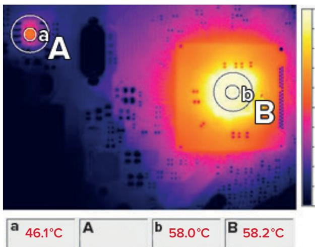
Если пятно измерения больше объекта, то температура рассчитывается по усредненному значению теплового излучения от объекта и окружающей среды.
