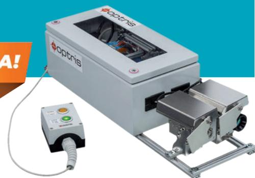
С ПОМОЩЬЮ НОВОЙ СИСТЕМЫ КОНТРОЛЯ ТЕМПЕРАТУРЫ МОЖНО БЫСТРО ОБНАРУЖИТЬ РАЗНИЦУ ТЕМПЕРАТУР В ПРОЦЕССЕ ЗАКАЛКИ СТЕКЛА, ЧТО ПОЗВОЛЯЕТ ИЗБЕЖАТЬ БРАКА И ОБЕСПЕЧИТЬ АВТОМАТИЧЕСКИЙ КОНТРОЛЬ КАЧЕСТВА.
