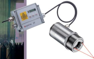
**Серия CTlaser** - двухкомпонентный ИК-пи-рометр состоит из измерительного датчика и отдельного блока электроники. В дополнение к простой настройке прибора и индикации температуры, блок электроники дает возможность выбора между различными интерфейсами: USB, RS232, RS485, Modbus RTU, Profibus DP и Ethernet.
