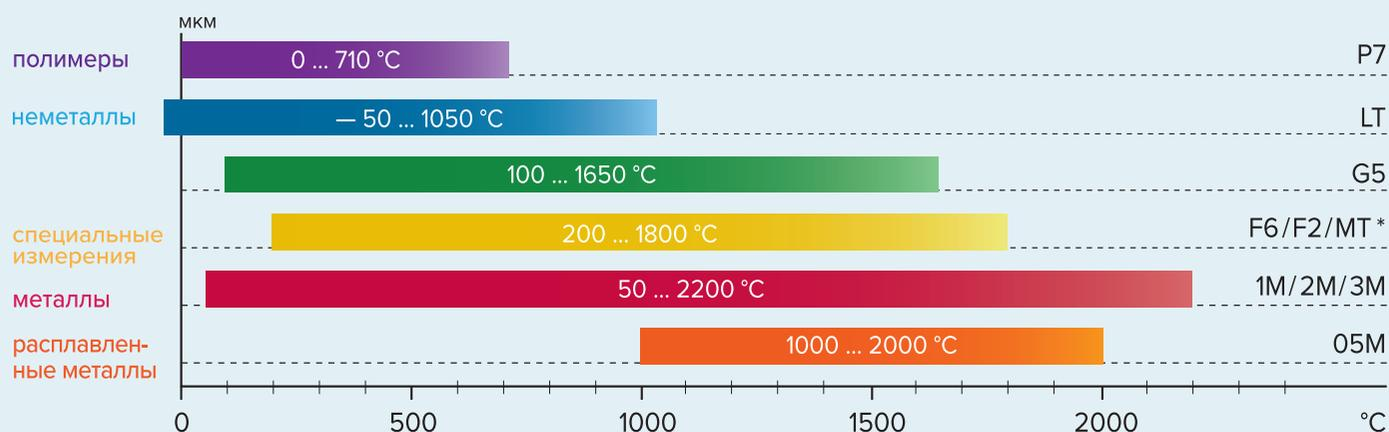
\* MT - измерение температуры через пламя; F2 - измерение температуры продуктов сгорания при наличии CO<sub>2</sub>
