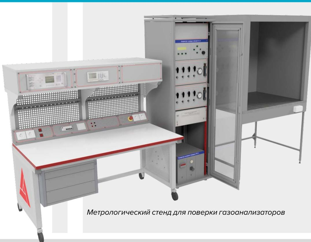
*Метрологический стенд для поверки газоанализаторов*
