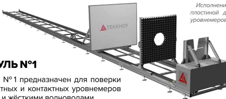
*Исполнение со съемной отражающей пластиной для поверки бесконтактных уровнемеров.*
