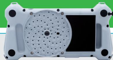
Портативная акустическая камера SONASCREEN отображает акустические изображения как в звуковом, так и в ультразвуковом диапазоне частот. Устройство обнаруживает источники звука в режиме реального времени и сразу отображает результаты на экране. В шумных помещениях камера позволяет работать с промышленными наушниками.
