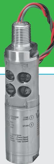
Внешние органы подстройки нуля, диапазона и калибровки герметизированы, но легко регулируются с помощью специально разработанных бесконтактных магнитных регуляторов. Формирователь сигналов в модели 571 позволяет перенастраивать стандартный диапазон измерений давления в масштабе 5:1. Модель 571 соответствует стандартам FM, CSA и CENELEC для работы в зонах Division 1/Zone 0 и Division 2.
