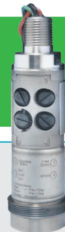
Модели 550 и 551 имеют прочную конструкцию диафрагмы из нержавеющей стали, которая может легко выдержать контакт с потоком цементного раствора. Модели имеют плёночную технологию изготовления чувствительного элемента и не имеют полости с масляным заполнением. Это обеспечивает легкую очистку без повреждения устройства в отличие от емкостных и тензорезистивных датчиков давления.
